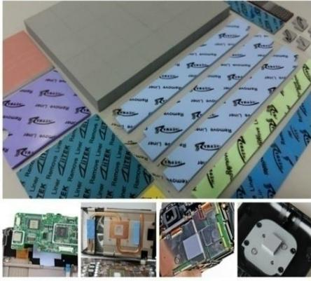
TIF™800HP系列是一种硅胶导热材料，它能填充发热器件和散热片或金属底座二者之间的间隙。它的柔性、弹性特征使其能够用于覆盖非常不平整的表面。其优异的效能使热量从发热器件或整个PCB传导到金属外壳或扩散板上，从而提高发热电子组件的效率和使用寿命。
