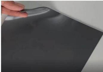
**TIF™900-30F** 系列吸波材料是一种高分子硅胶为基材，添加陶瓷粉、软磁颗粒以及相应的助剂制成的复合材料，其较低压力下可实现低界面热阻性能和电磁吸波性能，能够填充缝隙，完成发热部位与散热部位间的热传递和电磁噪音吸收；同时还起到绝缘、减震、密封等作用，满足设备小型化及超薄化的设计要求。
